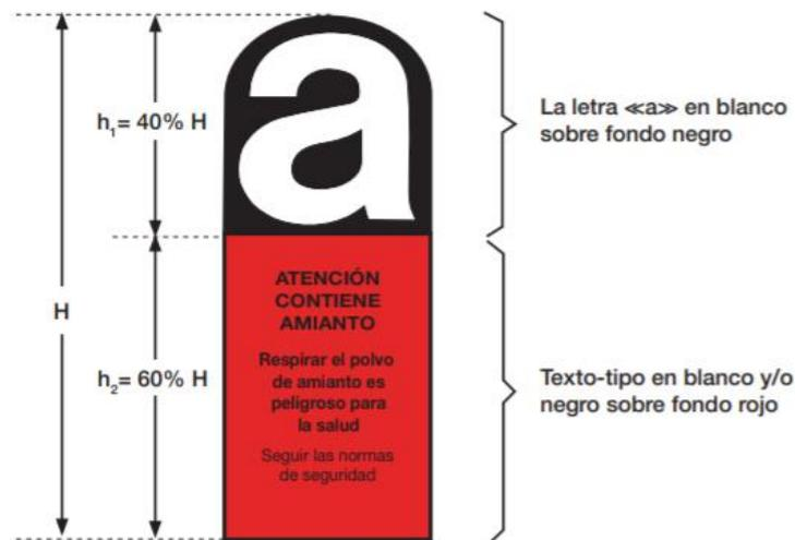
Figura 4. Etiqueta reglamentaria de identificación de materiales con amianto [14].
